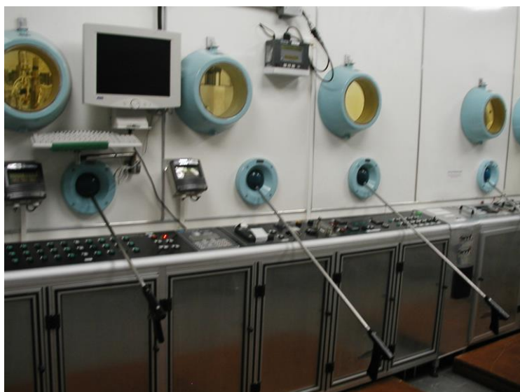
Vista frontal de Célula de processamento de radiofármacos do IPEN
